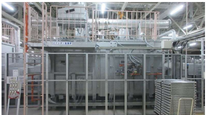
脱脂炉 (アルミろう付の前処理工程)
