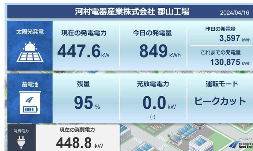
太陽光発電容量… 1, 500 kW / 蓄電池容量… 150 kWh
